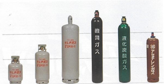
ガスボンベは、ガスの種類によって色分けされている。因みに酸素ガスは黒色、液化炭酸ガスは緑色、アセチレンガスは茶色、LPガスはグレー。
