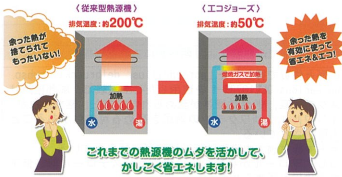
エコジョーズのしくみ（一般社団法人日本ガス石油機器工業会資料）
