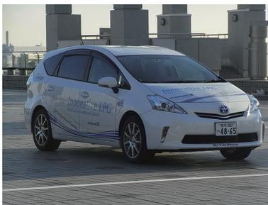
LPG、ガソリン、電気の併用により、航続距離1,500km以上(同社測定値)を達成。
