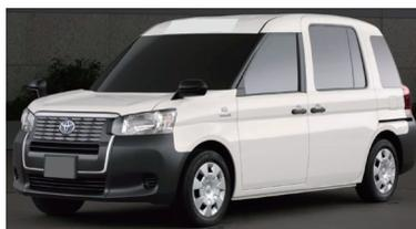
LPG、電気のハイブリッドにより、航続距離約800km(カタログスペックにより計算)の走行が可能。
