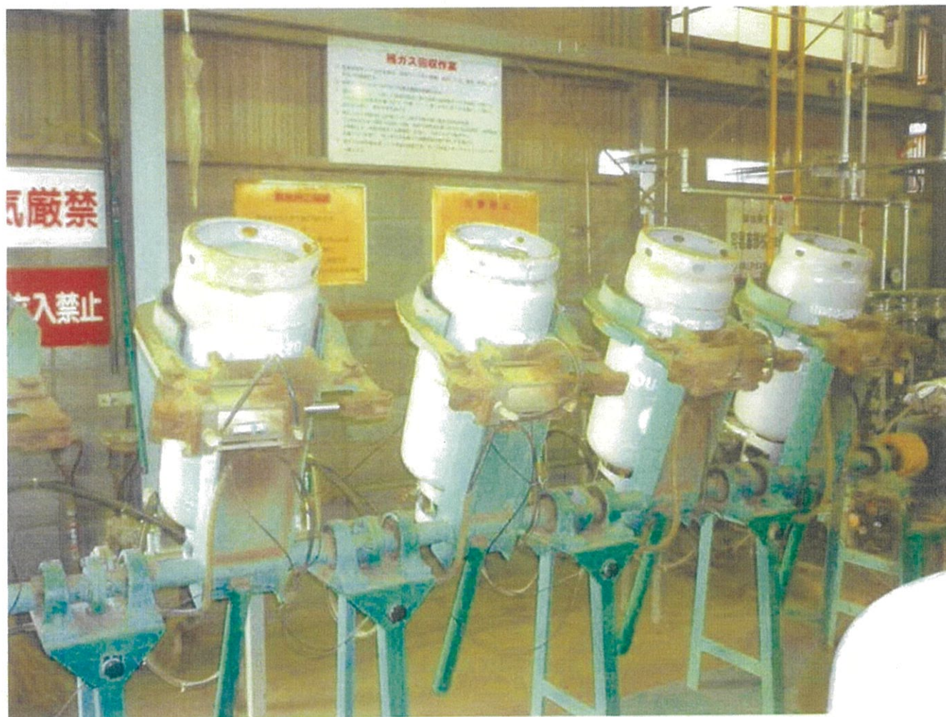
容器からの残液回収作業
