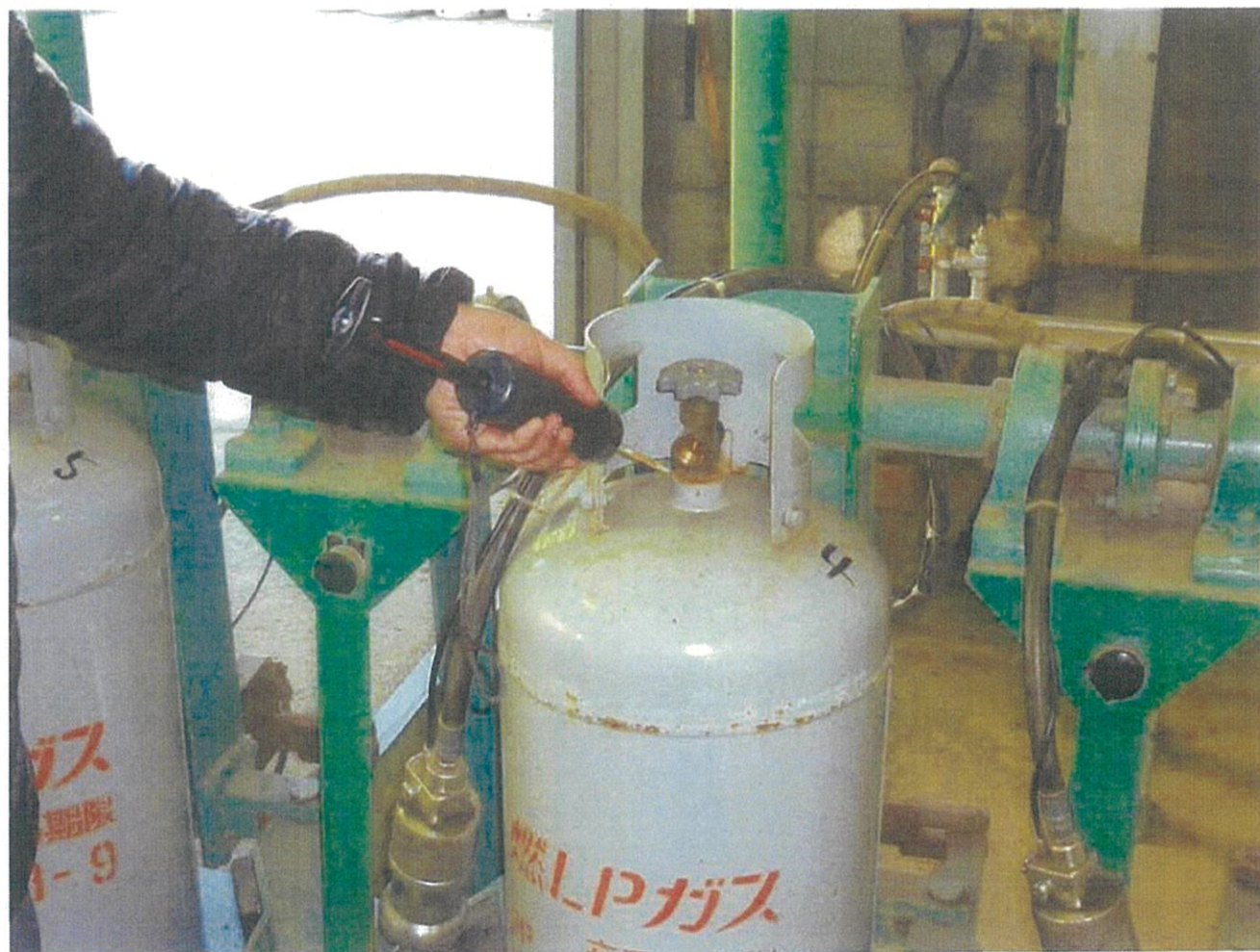
残液回収後の容器からのブタンの漏れを測定
