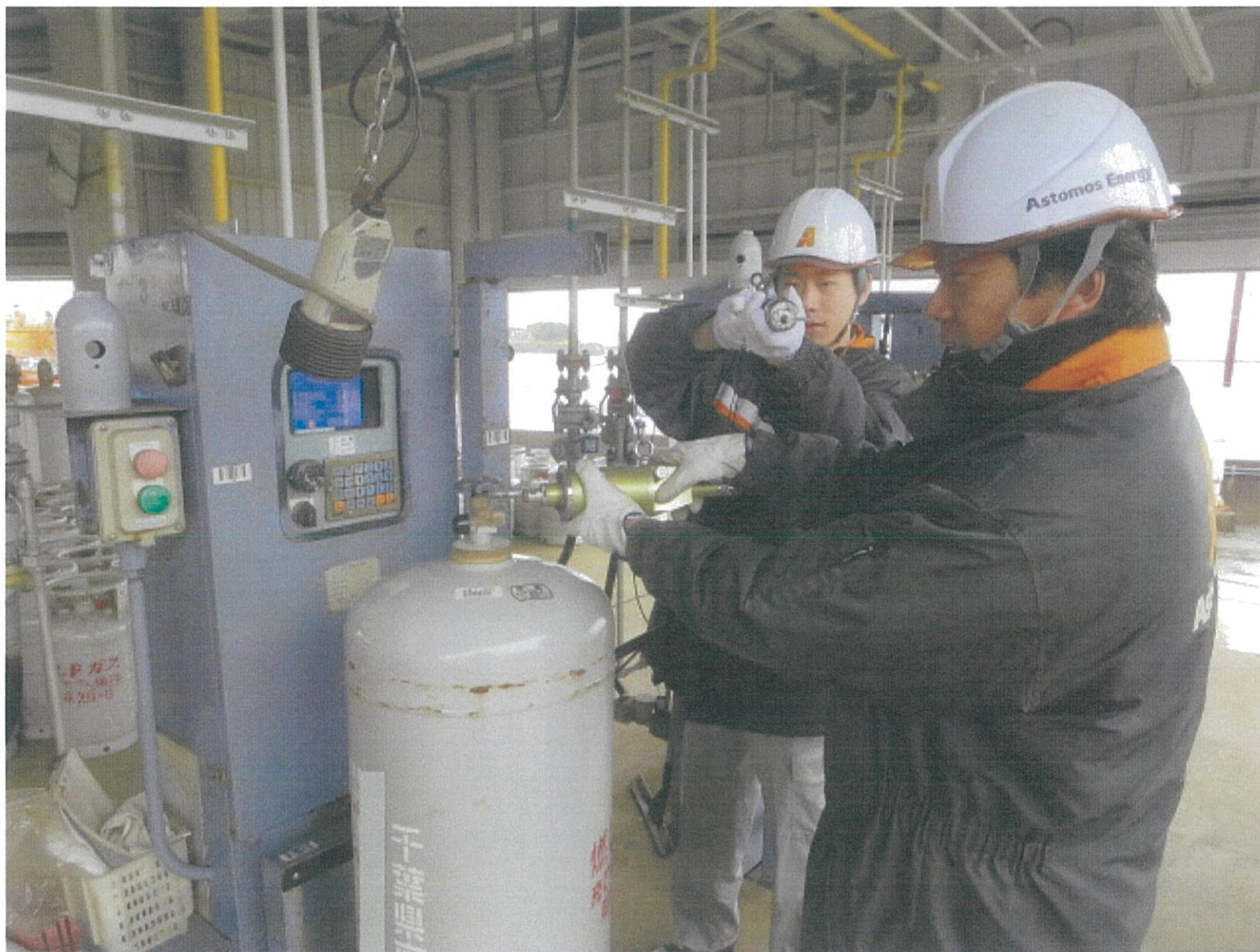
容器充填作業時のブタン濃度測定
