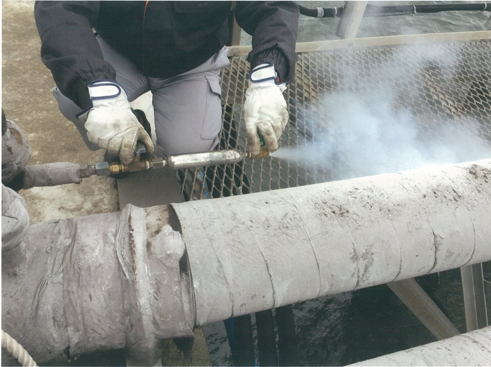
受入LPガスサンプリング作業時（容器共洗いによるLPガス放出）
