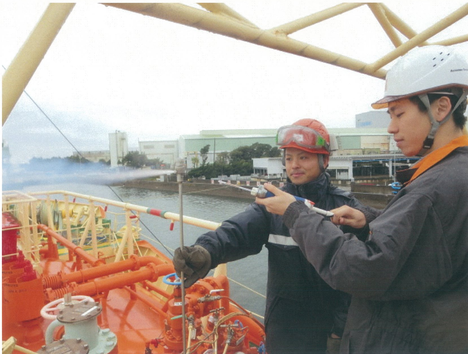
内航船受入作業検尺時のブタン濃度測定
