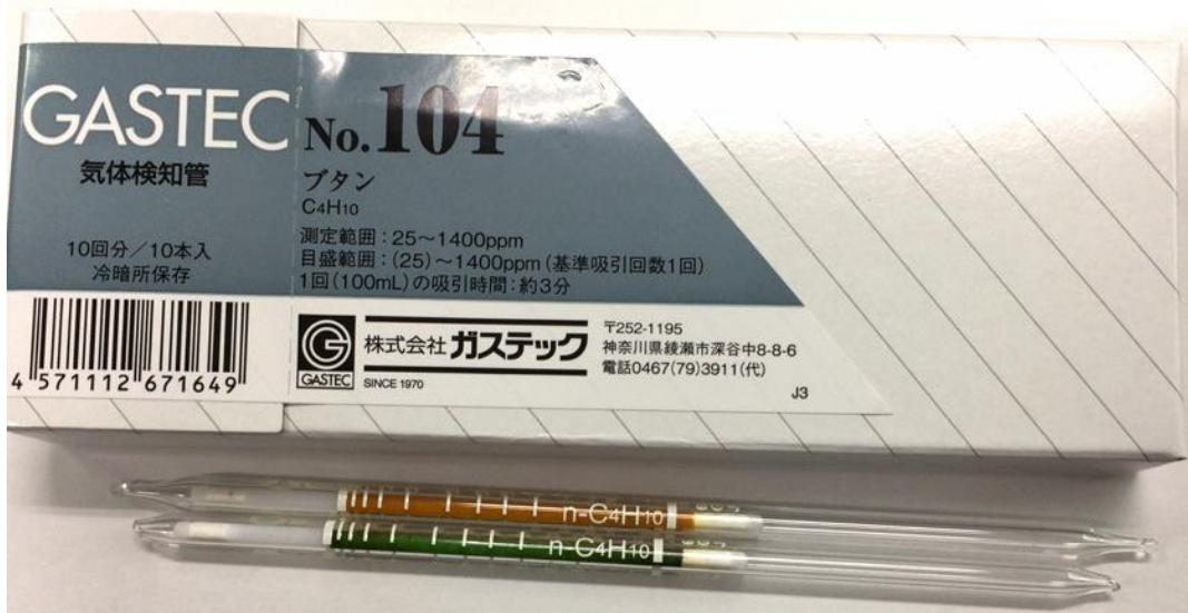
※試験器具に検知管を装着して吸引する。環境中のブタンを検出するとオレンジ→緑に管内の検知材が変色する。変色した部位の目盛りを読みとり、濃度を定量できる。尚、検知管でのLPガス中の危険・有害性物質の測定範囲（例）は以下の通りです。
