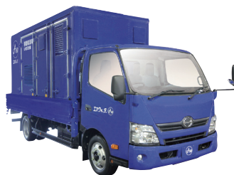
50kW級 移動電源車 発電ユニット搭載タイプ
