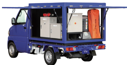
9.8kW 移動電源車 軽自動車タイプ
