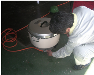
バルク貯槽ユニットに備え付けられたガス栓にホースを接続し消費機器と接続。写真は平成23年3月11日の地震発生直後に炊き出しに利用される災害対応バルク。（I・T・O(株) 仙台営業所）
