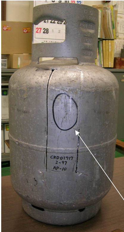
縦方向に発生した亀裂
